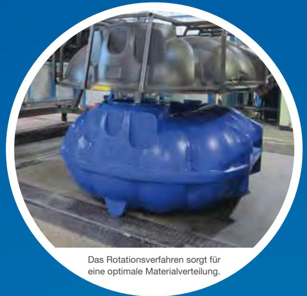
Das Rotationsverfahren sorgt für eine optimale Materialverteilung.
